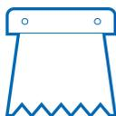
Нанести клей на основание соответствующим зубчатым шпателем, при этом посредством равномерного ведения зубчатого шпателя избегать образования клеевых гнезд и слишком толстых слоев клея. В течение указанного для укладки времени уложить паркет в клей, немного задвинуть и плотно прижать.
